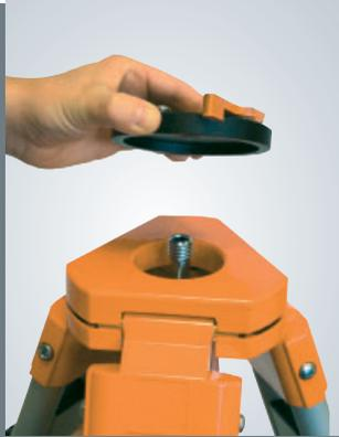
Beim Nachrüsten wird die Quick-Fix Adapterplatte mit der Halteschraube auf dem Stativ und der runde Quick-Fix Adapter am Instrument befestigt.
