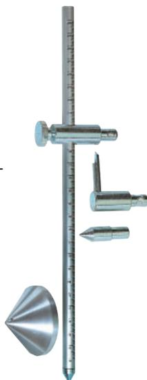
Die serienmäßig zum Lieferumfang gehörenden Messspitzen erlauben auch Messungen an schwer zugänglichen Stellen. Selbst Abstände zweier nicht in einer Ebene liegender Punkte lassen sich schnell und einfach ermitteln. Mit Hilfe der ebenfalls zum Lieferumfang gehörenden Messkegel ist auch die Bestimmung von Bohrungsabständen kein Problem.
