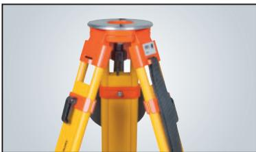
Geodäten bevorzugen für Hochpräzisionsinstrumente jedoch Holz-Stativ. Im Vergleich zu Aluminium-Stativen haben Holz-Stativ bei Vibrationen ein besseres Dämpfungsverhalten. Darüber hinaus reagieren Holz-Stativ unempfindlicher auf Temperaturschwankungen. Die Holzteile aller Nedo Holz-Stativ werden durch die Beschichtung mit einem Hightech Kunststoffmaterial dauerhaft vor Feuchtigkeit geschützt. Dadurch sind Nedo Holz-Stativ extrem witterungsbeständig und robust.
