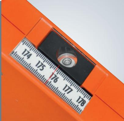
Auf der Analoganzeige des Nedo **Laser mEssfix-S** kann bequem der Höhenunterschied zwischen der Null-Linie des Laserempfängers und dem Aufsetzpunkt des **Laser mEssfix-S** abgelesen werden.
