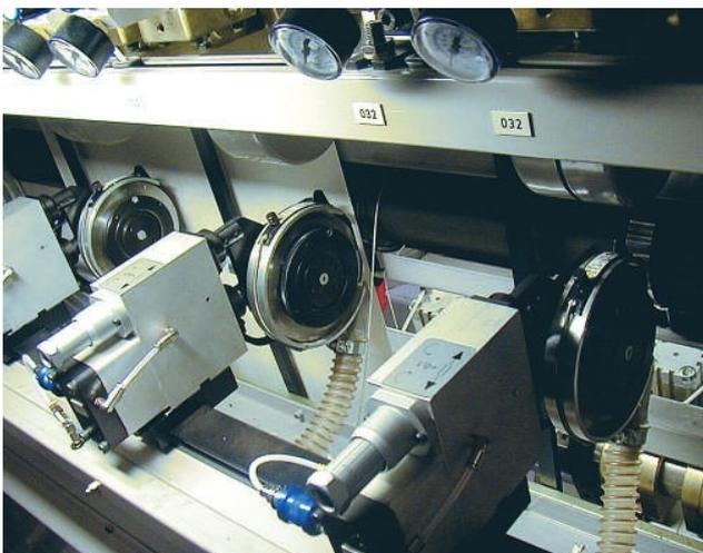
Saughauben an Schneidmessern von Druckmaschinen
