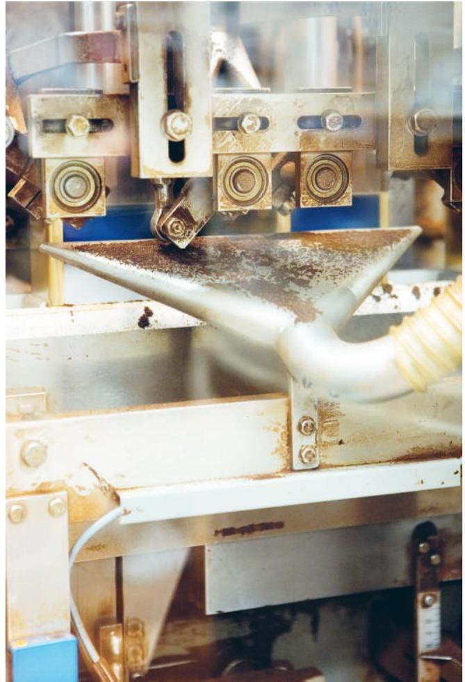
Absaugung an einer Verpackungsmaschine der Nahrungsmittelindustrie
