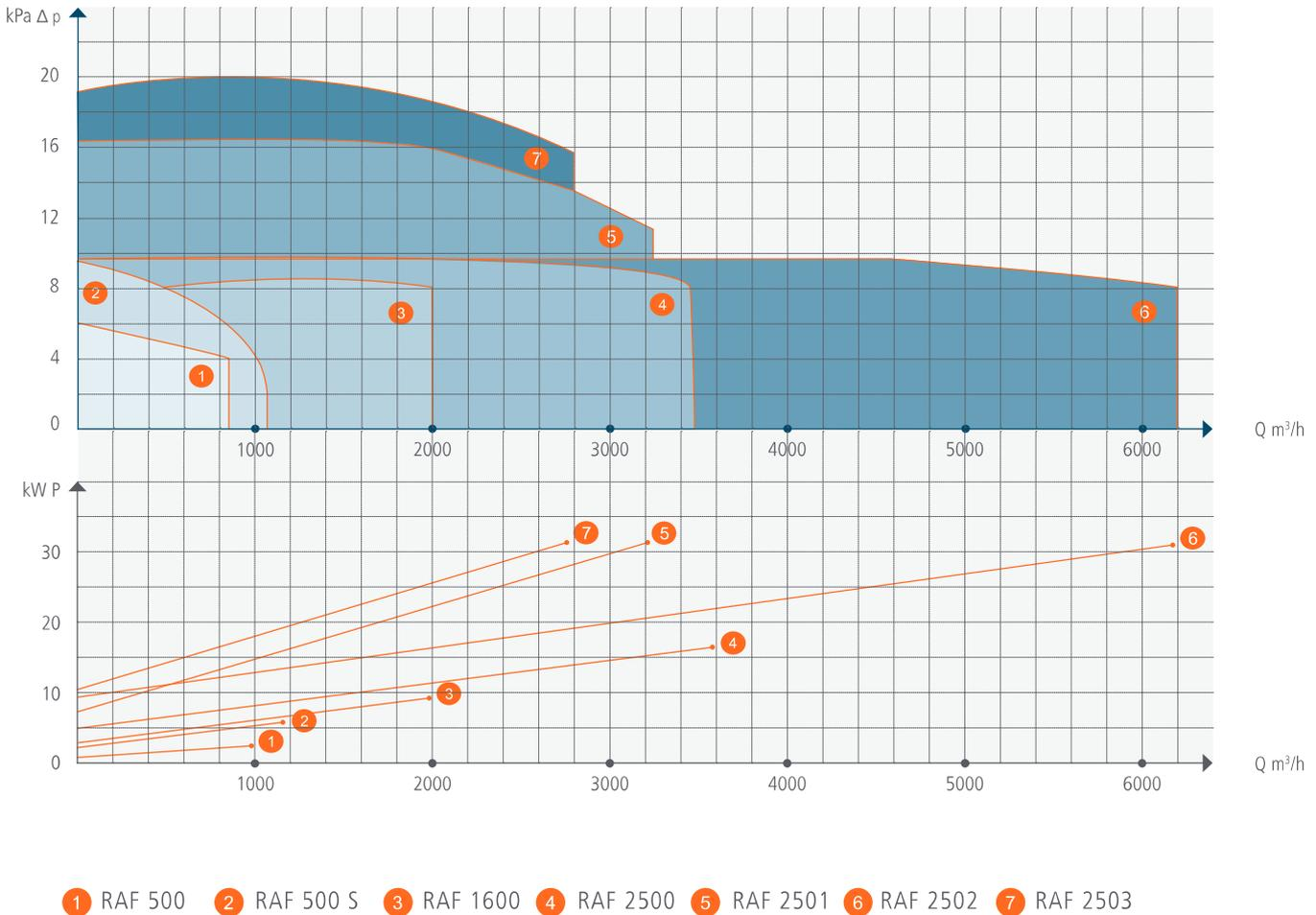
Die Leistungskurven der Dustcontrol-Vakuumerzeuger wurden gemessen und empirisch aufgeführt. Die Druckverluste bei normalen Auslässen (Schalldämpfer, Rückschlagklappe/Bogen) wurden in der Kurve berücksichtigt. Weitere Adaptionen, z. B. ein Diffusor, können zu höheren Druckverlusten führen und müssen ebenfalls berücksichtigt werden. Die angegebenen Luftstromwerte gelten für Luft bei normalem Druck (101,3 kPa) und normaler Temperatur (20 °C).
