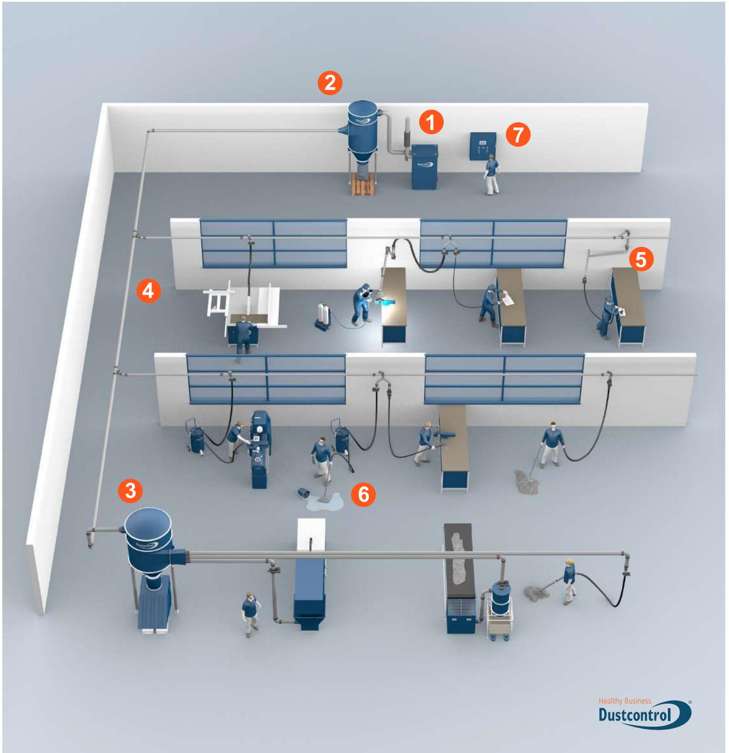
Um den gewünschten Wirkungsgrad und die Vorteile des Absaugsystems zu erhalten, ist ein komplettes System notwendig; von den Saughauben über den Vakuumerzeuger zum Steuerungssystem. Alle Komponenten des Systems sind gleichermaßen wichtig für die Funktion.
