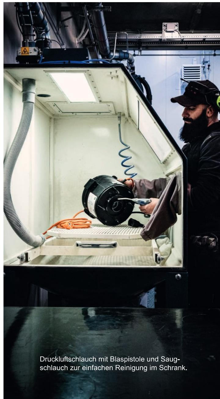
Druckluftschlauch mit Blaspistole und Saugschlauch zur einfachen Reinigung im Schrank.
