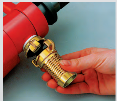
Saugtülle ankuppeln - bereit zum Trockenbohren
