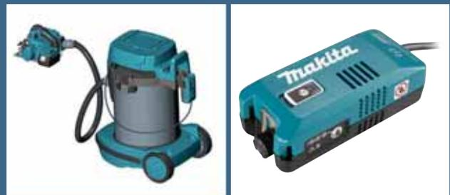
Mit dem Adapter WUT02 können alle netzbetriebenen Sauger von Makita via Bluetooth automatisch gestartet werden. Einfach den Stecker des Adapters in die Gerätesteckdose des Saugers stecken, den Sauger auf „Auto-Start“ stellen und den Bluetooth-Adapter mit einem AWS-fähigen Werkzeug koppeln. Wird dann die Akku-Maschine gestartet, läuft der Sauger automatisch an.
