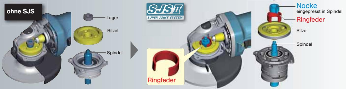
So funktioniert das Super Joint System II
